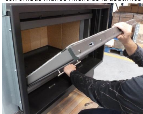
Figura n°42 - Paso intermedio al abatir
