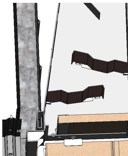
Figura nº29 - Vista de sección Itaca 80 eco con los deflectores colocados
